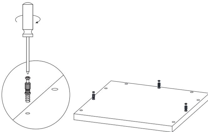
② 將側板、中立板(雙排櫃以上才有中立板)、背板依木栓定位插入底板。
