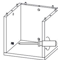
④ 頂板闔上後安裝對應的KD螺帽，以起子鎖緊，完成組裝。如有活動格板，則於側板排孔裝上層板粒，放上格板即完成。
