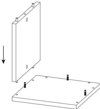
③ 就位後，於木板相接處，將KD螺帽以垂直於木板邊緣的箭頭方向塞入對應的大圓孔中，再用起子鎖緊。相鄰木板將緊密接合完成。
