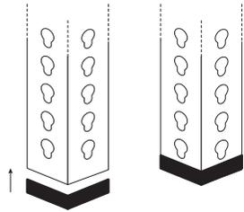
② 先組兩側短邊橫桿，依據您的每層高度組裝短桿，每個水滴孔距三分公，可微調，並靠住牆面支撐。組裝時以膠槌敲入，使橫桿卡榫確實卡入立柱的水滴孔中。
