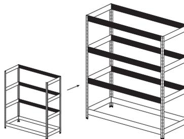
⑤ 補強以斜邊朝下卡入橫桿中，再以膠槌敲擊補強，使之轉九十度確實卡入橫桿中。依序安裝每層補強。
